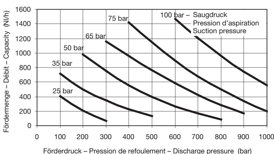
Fördermenge (NI/h) in Abhängigkeit des Saugdruckes und des Förderdruckes, gemessen mit N<sub>2</sub> bei Druckluftversorgung von 6 bar.
